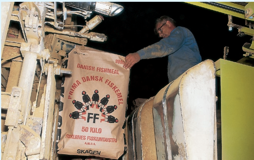
Efterspørgslen efter specialmel var fortsat stigende, og her vises udsækningsmaskinen, der erstattede, at melsækkene skulle fyldes manuelt op med de 50 kg fiskemel!
